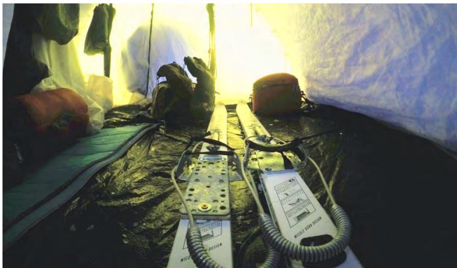
1. Треснула прижимная планка на щёчке креплений у Пичугина Андрея. Усилили прижимную планку металлической пластиной. Отверстия в пластине пришлось пересверливать при помощи ручной сверлильной установки.
