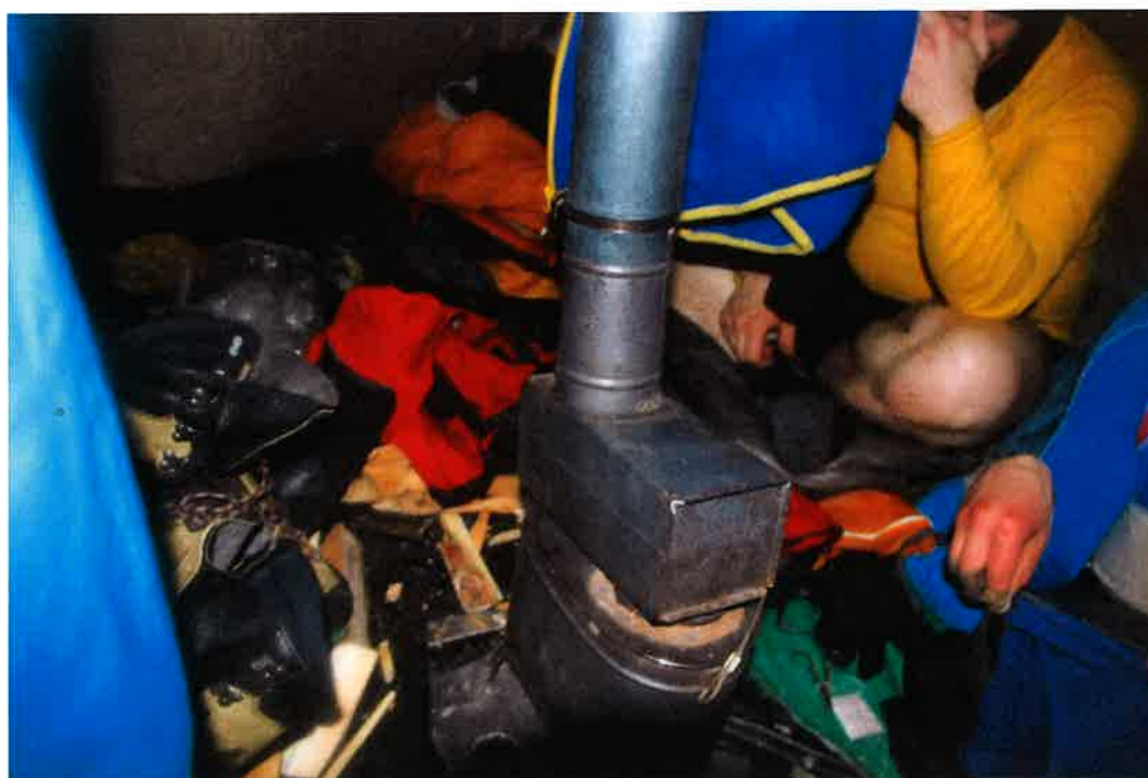
Фото 5. Печка в шатре, сверху – экономайзер (искрогаситель). Труба – лист.
